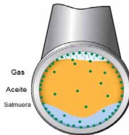
La sección de tubería muestra la protección activa de los VpCI® en la interfase entre el líquido y vapor.
